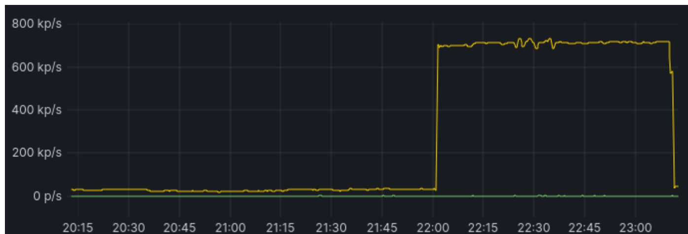
Primer povečanja prometa med volumetričnim DDoS napadom.
